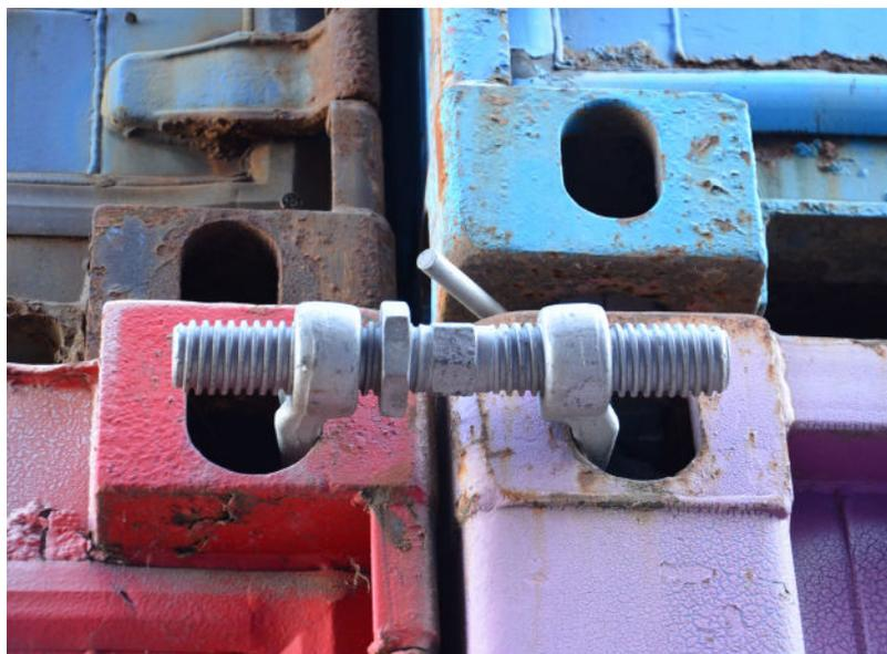
Très simple d'utilisation et rapide à mettre en place, le bridge fitting est un accessoire permettant de lier 2 containers maritimes en les verrouillant l'un à côté de l'autre par les coins ISO. Il suffit d'insérer les 2 crochets dans les trous oblongs des coins ISO, et de serrer l'écrou central avec une clé 6 pans.
